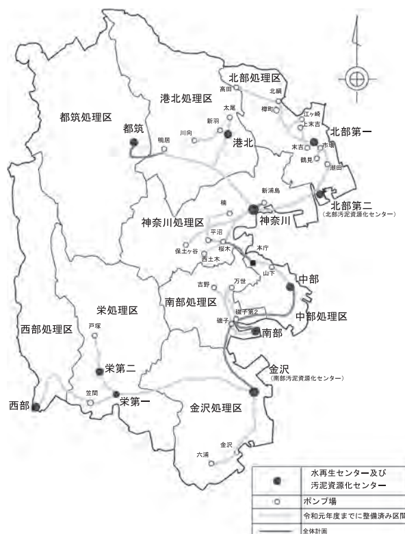
図1 横浜市下水道光ファイバーケーブル布設計画図
