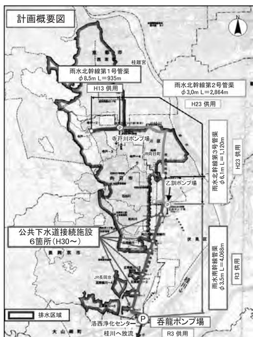
図1 いろは呑龍トンネルの計画概要図
