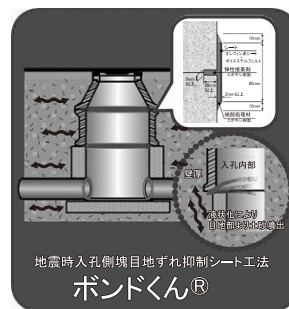
図3 人孔側塊部の目地ズレ防止工法（例）
