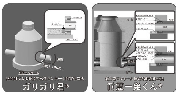
図1 管口の耐震化工法（例）
